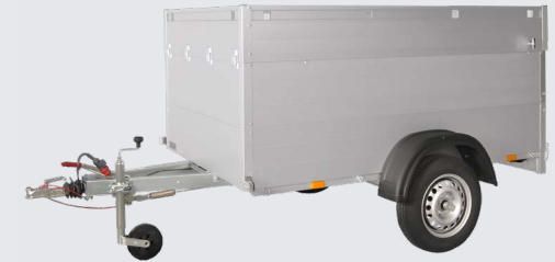
GT-HT Einachsanhänger gebremst (Kastenhöhe innen 83 cm)
