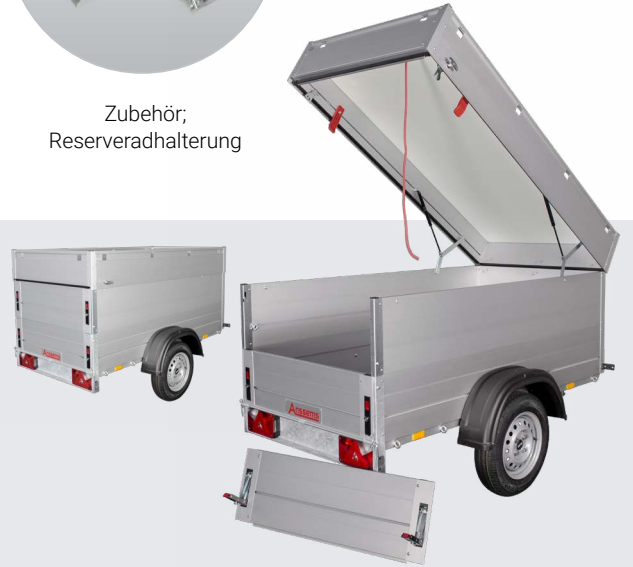
Die zusätzliche Hinterbordwand ist auch abschließbar
