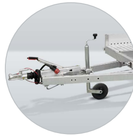
Lange Deichsel aus Rechteckrohrprofil
