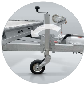
Zubehör: Klappbares Stützrad ermöglicht Weiterfahrt
