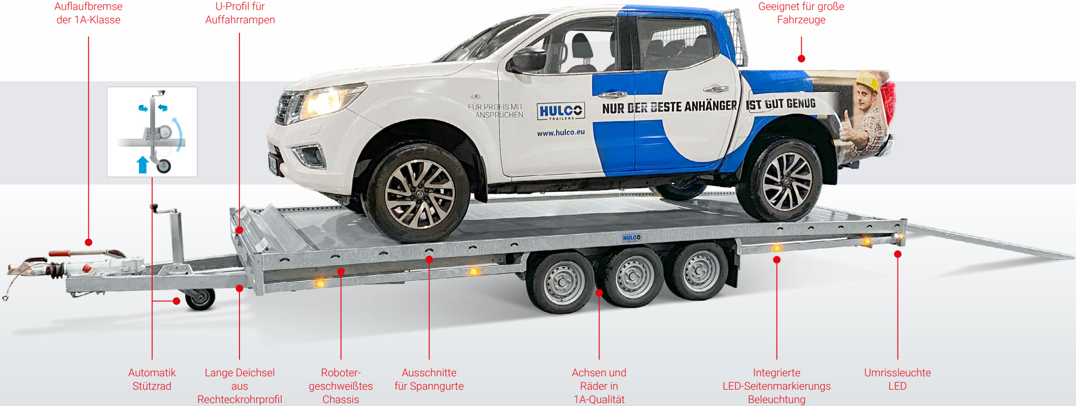
Extrem stabiles Fahrgestell mit optimaler Bodenunterstützung
